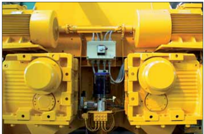
Zwangssynchronisation beider Antriebe über eine Gelenkwelle am Beispiel eines EMDW 3500 Forced synchronization of both drives via cardan shaft shows as an example of the EMDW 3500
