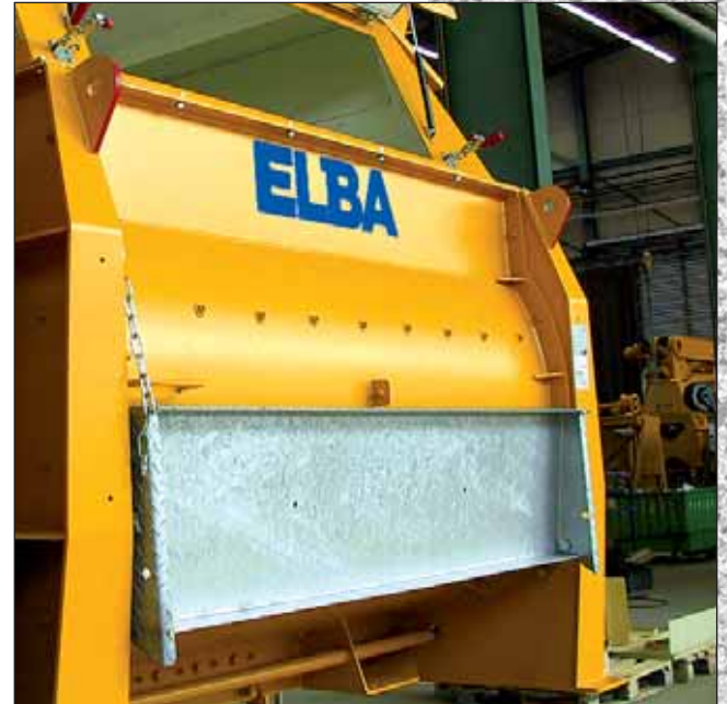
Gute Zugänglichkeit durch klappbare verzinkte Podeste. Good accessibility due to hinged galvanized platforms.
