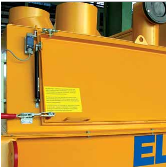
Großzügig dimensionierte Wartungs- und Reinigungsöffnung. Durch Öffnungshilfen leicht zu bedienen. Berührungsschutz durch zwangsbetätigte Endschalter. Generously dimensioned maintenance and cleaning gate. Easy to open via opening aids. Protection against contact by mechanical limit switches.
