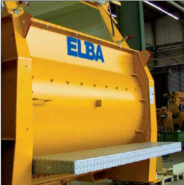
Gute Zugänglichkeit durch klappbare verzinkte Podeste. Good accessibility due to hinged galvanized platforms.
