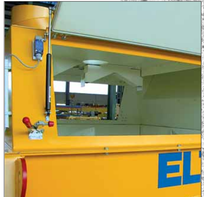
Großzügig dimensionierte Wartungs- und Reinigungsöffnung. Durch Öffnungshilfen leicht zu bedienen. Berührungsschutz durch zwangsbetätigte Endschalter. Generously dimensioned maintenance and cleaning gate. Easy to open via opening aids. Protection against contact by mechanical limit switches.
